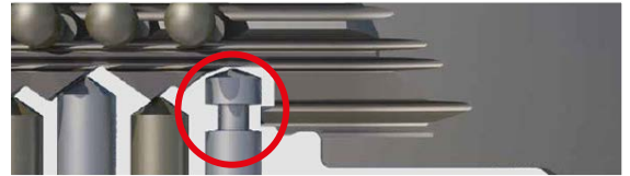
Intop-Prüfeinheit am Schlüssel und im Zylinder
