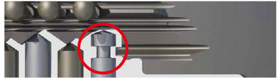
Intop-Prüfeinheit am Schlüssel und im Zylinder
