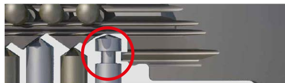
Intop-Prüfeinheit am Schlüssel und im Zylinder
