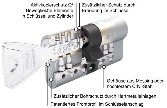
Zwei voneinander unabhängige Bohrlinien und bis zu 15 gehärtete Pins (Zuhaltungsbolzen) ergeben eine komplexe Kombinatorik der Schließanlage. Das garantiert nicht nur eine herausragende Sicherheit, sondern auch eine hohe Wirtschaftlichkeit. So lässt sich Ihre Anlage jederzeit ausbauen und erweitern. Das sorgt für mehr Flexibilität und eine optimale Investitionssicherheit.
